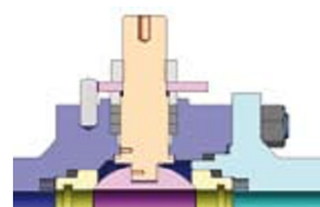
Budowa trzpienia i pokrywy dla temperatury do 400 °C / Design of stem and bonnet joint for temperatures 400 °C max.
